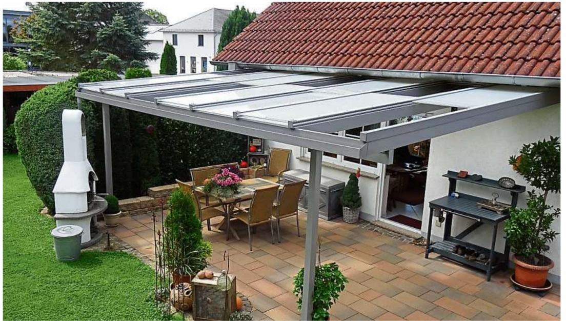
Verschiebbare Dachplatten belüften die Terrasse im Sommer und erleichtern die Reinigung.
